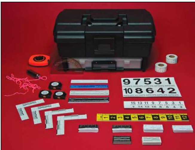
Figura 91. Maletín (kit) con materiales para análisis de patrones de manchas de sangre.
