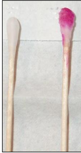
Figura 21. Prueba positiva de Kastle Meyer.
